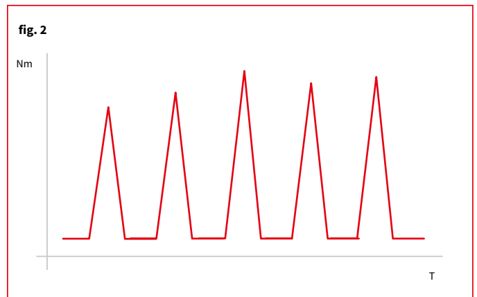
Diagramma della coppia di serraggio in un avvitatore a massa battente.
