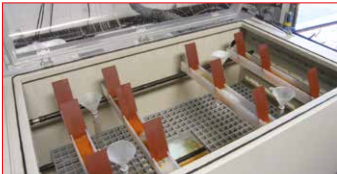
Camera per test corrosione INOX in nebbia salina.
